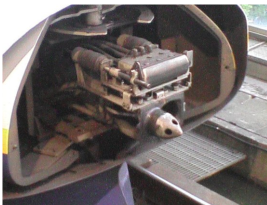
図.2 新幹線用密着連結器
