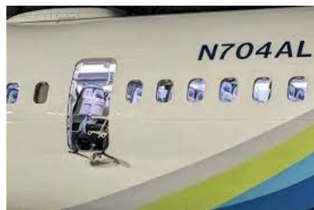
図.1 客室ドアが離脱したアラスカ航空の 737MAX9
