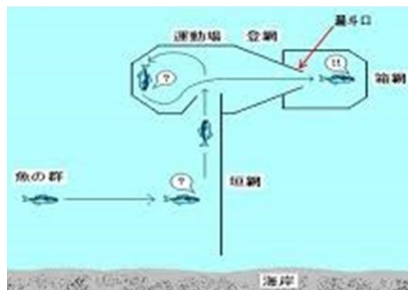
図.2 定置網の仕組み
