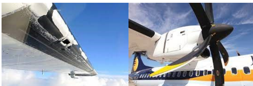
図.4 主翼前縁部分の着氷とエンジンの空気吸入口
